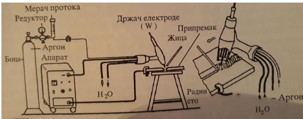
Слика 1. Заваривање ТИГ поступком
