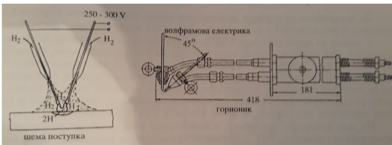
Слика 3. Заваривање АРК-АТОМ поступком
